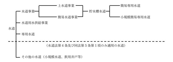
水道の中で、一定の要件に該当する寄宿舎、社宅、団地、学校、レジャー施設等の自家用の水道その他水道事業の用に供する水道以外の水道は「専用水道」として法的に種々の規制を受け、安全な水を安定的に供給しなければなりません。
